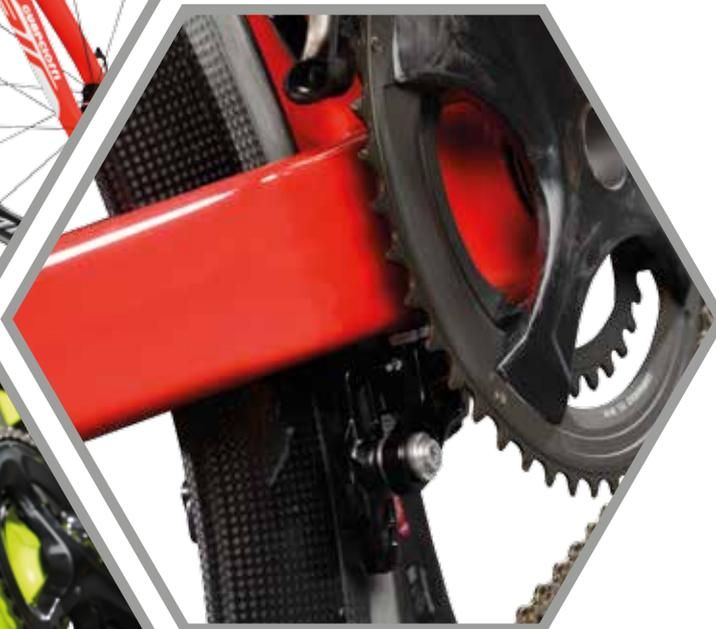
Eureka Air prevede l'uscita del cavo del cambio dietro al forcellino, incrementando così l'aerodinamica. *Eureka Air provides the output of rear derailleur cable behind the drop out, increasing the aerodynamics.*
