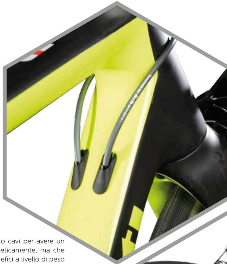
Sistema di passaggio cavi per avere un telaio più pulito esteticamente, ma che porta anche dei benefici a livello di peso complessivo.
