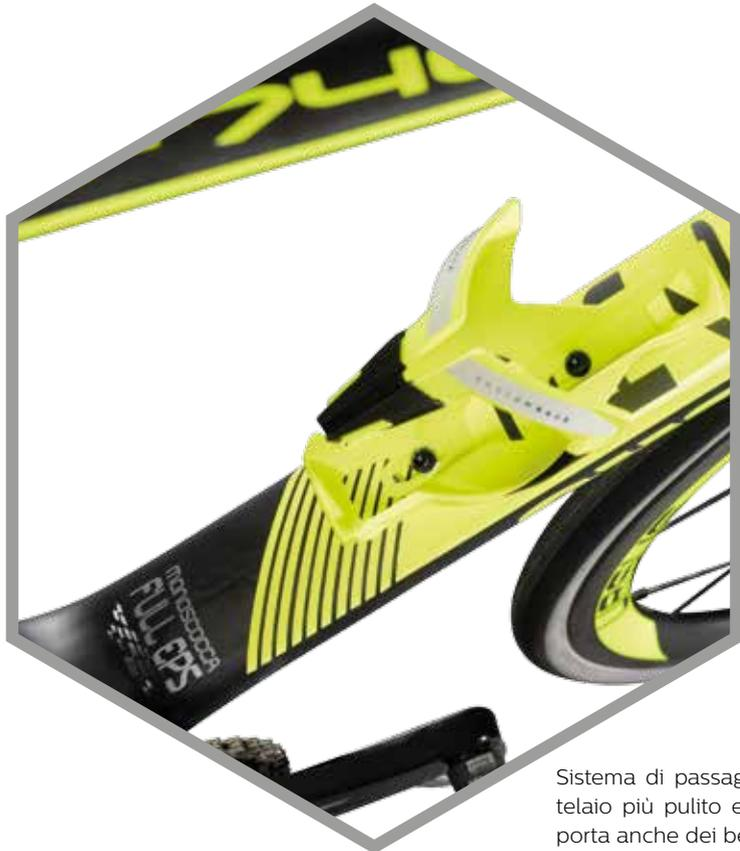
E740 è un telaio monococca, realizzato in un solo pezzo in stampata unica (come il modello Eureka Air), grazie alla tecnologia Full EPS. Questo sistema permette di ottenere un telaio più leggero, ma nello stesso momento più resistente a più elevati carichi di peso.
